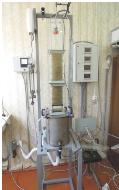
Рис. 2. Регулярная сетчатая насадка с упругим жидкостным распределителем (модификация Свиридова) и фото экспериментальной установки
