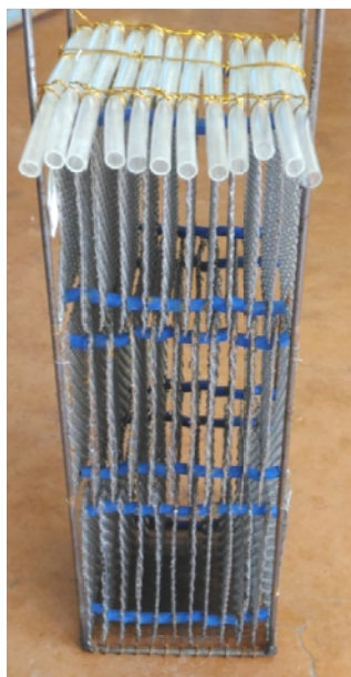
Рис. 2. Регулярная сетчатая насадка с упругим жидкостным распределителем (модификация Свиридова) и фото экспериментальной установки
